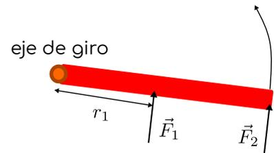
Figura 1.26: Resulta más fácil hacer girar una puerta aplicando una fuerza más lejos del eje como  $F_2$  que en una posición más cercana como la de  $F_1$ .
