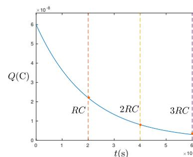
Figura 4.41: Descarga de un condensador en un circuito RC serie.  $R = 2 \Omega$  y  $C = 1 \mu\text{F}$  dan un tiempo de descarga  $\tau = RC = 2 \mu\text{s}$ . El condensador comienza con una carga  $Q_0 = CV_{bat}$  con  $V_{bat}$  el voltaje que se aplicó al condensador para cargarlo inicialmente. Las rayas verticales discontinuas marcan los tiempos  $t = \tau$ ,  $t = 2\tau$  y  $t = 3\tau$ .
