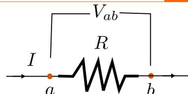
Figura 4.37: La diferencia de potencial  $V_{ab}$  en los extremos de la resistencia  $R$  hace que circule una intensidad dada por la ley de Ohm  $I = \frac{V_{ab}}{R}$ . La potencia consumida o disipada en forma de calor es  $P = IV_{ab}$ .
