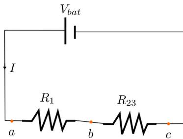
Figura 4.35: Paso 1. Circuito equivalente tras sustituir la combinación  $R_2$  en paralelo con  $R_3$  por su resistencia equivalente  $R_{23}$ .
