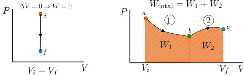
Figura 3.30: Izquierda: **Proceso isócoro**. El trabajo es nulo pues no hay expansión ni compresión. Derecha: **Suma de procesos** El trabajo total es la suma (algebraica) de los trabajos individuales
