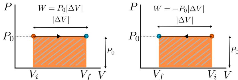
Figura 3.28: **Proceso isóbaro.** Un gas se expande (izquierda) o comprime (derecha) a presión constante  $P_0$ . En ambos casos, el trabajo coincide numéricamente con el área encerrada bajo la línea del proceso (área naranja rallada). En el caso de la expansión  $W = +$ “área” mientras que en la compresión  $W = -$ “área”
