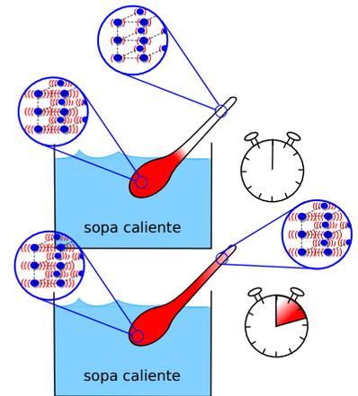
Figura 3.12: Visión microscópica de la transmisión del calor: la energía cinética de vibración (proporcional a la  $T$ ) se transmite a través de la red cristalina de los átomos del material.
