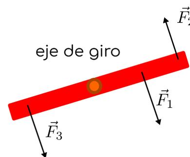
Figura 1.28: Los torques tienen signo.  $F_2$  y  $F_3$  dan lugar a un torque positivo, mientras que  $F_1$  ejerce un torque negativo.
