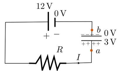
Figura 4.38: Circuito RC en el proceso de carga. Inicialmente el potencial del condensador ( $V_a - V_b$ ) es bajo, la intensidad alta. La corriente que llega al condensador carga las placas del condensador y se opone al potencial de la batería, reduciendo la intensidad que circula por el circuito. Finalmente, cuando los potenciales se igualan, la corriente es nula y la carga no aumenta más.
