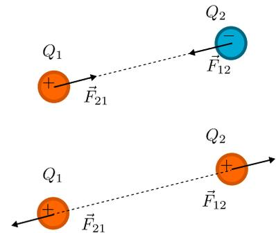
Figura 4.3: Arriba: fuerzas entre cargas de distinto signo. Abajo: fuerzas entre cargas de igual signo. En ambos casos,  $\vec{F}_{12}$  es la fuerza que la carga 1 hace sobre la carga 2 y  $\vec{F}_{21}$  la fuerza que ejerce 2 sobre 1. Nótese que las fuerzas se pintan sobre los objetos que las sienten.
