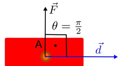
Figura 1.4: Si  $\vec{F} \perp \vec{d} \Rightarrow W = 0$
