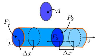
Figura 2.23: Fluido viscoso fluyendo como resultado de una diferencia de presiones en sus extremos  $P_1 - P_2$ . Se desplaza una distancia  $\Delta x$  en un tiempo  $\Delta t$ , a velocidad  $v = \Delta x/\Delta t$ .
