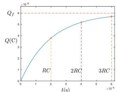
Figura 4.39: Carga de un condensador en un circuito RC serie.  $R = 2 \Omega$  y  $C = 1 \mu F$  dan un tiempo de carga  $\tau = RC = 2 \mu s$ . La raya discontinua horizontal marca el valor final de carga  $Q_f = CV_{bat}$  con  $V_{bat}$  el voltaje aplicado al condensador para cargarlo. Las rayas verticales discontinuas marcan los tiempos  $t = \tau$ ,  $t = 2\tau$  y  $t = 3\tau$ .
