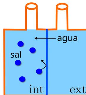
Figura 3.8: Inicialmente las dos cámaras están a igual presión y temperatura. La membrana semipermeable deja pasar el agua (solvente) pero no la sal (soluta). Por difusión del *agua*, esta comienza a pasar hacia la zona de alta concentración de *sal*.
