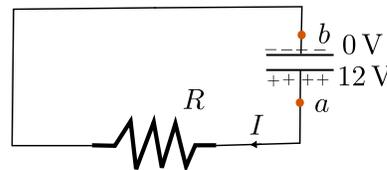
Figura 4.40: Circuito RC en el proceso de descarga. Inicialmente el condensador se cargó utilizando una batería de 12 V y el voltaje del condensador ( $V_a - V_b = 12$  V). Se establece una corriente alta inicialmente y el condensador se descarga, disminuyendo su carga y potencial de forma exponencial hasta. La carga positiva se traslada a través del circuito hasta la placa negativa compensándose la carga. La descarga finaliza cuando no queda carga en el condensador.
