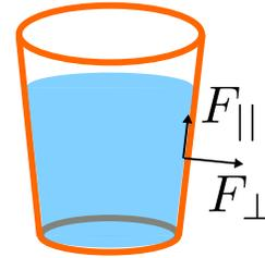
Figura 2.3: En un fluido en reposo las fuerzas de presión son perpendiculares a las superficies.
