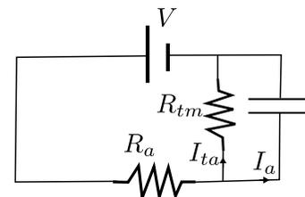
Figura 4.53: Circuito equivalente del axón sin vaina de mielina. Parte de la corriente generada se pierde a través de la membrana  $I_{tm}$  y no en depolarizar el siguiente segmento de membrana, ralentizando la transmisión.
