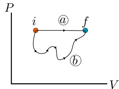
Figura 3.36: **Entalpía es función de estado.** Dos procesos  $a$  y  $b$  que empiezan y acaban en los mismos estados tienen la misma variación de entalpía. Solo en el proceso  $a$  a  $P = \text{cte.}$  se cumple que  $Q = \Delta H$ .
