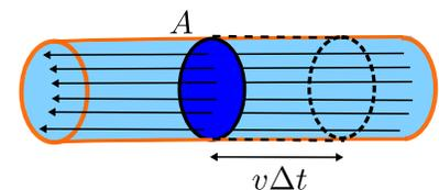
Figura 2.13: Caudal o flujo de masa. La cantidad de fluido que atraviesa la sección perpendicular de tubería en un intervalo de tiempo  $\Delta t$  es la que se encuentra a una distancia  $v\Delta t$  o menor en la dirección del movimiento.
