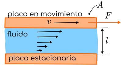
Figura 2.22: Definición de viscosidad. Vista lateral del experimento. La placa inferior está fija. Para mover la placa superior con velocidad constante  $v$ , es necesario aplicar una fuerza constante  $F$ . Las placas, aunque no se aprecia, tienen una superficie  $A$ .
