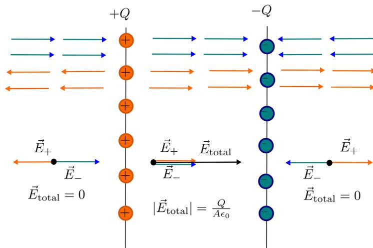
Figura 4.15: **Arriba:** El campo entre 2 planos cargados con  $+Q$  y  $-Q$  apunta en el mismo sentido en la región entre los planos y en sentidos contrarios en el exterior de las placas. **Abajo:** Suma vectorial de los campos generados por cada plano.
