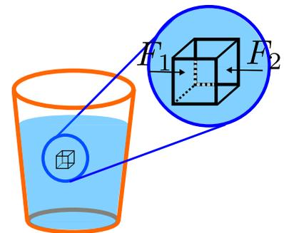
Figura 2.2: Fuerzas debidas a la presión en el seno de un fluido en reposo. Las fuerzas son iguales en todas direcciones (por ejemplo  $F_1 = F_2$ ). Si no fuera así habría fuerza neta en un sentido y no se mantendría el reposo.
