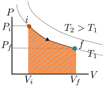
Figura 3.32: **Proceso isoterma.** Isothermas de gas ideal  $P = nRT/V$  y trabajo en un proceso isoterma desde  $i$  hasta  $f$ .
