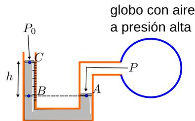
Figura 2.6: Manómetro en U, relleno de mercurio, para medida de presiones manométricas.
