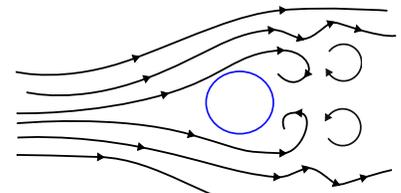
Figura 2.12: Flujo turbulento. Las trayectorias son irregulares, pueden aparecer remolinos.
