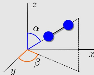
Figura 3.26: Una molécula diatómica tiene 2 grados de libertad adicionales (a los 3 de traslación) asociados a las posibles rotaciones
