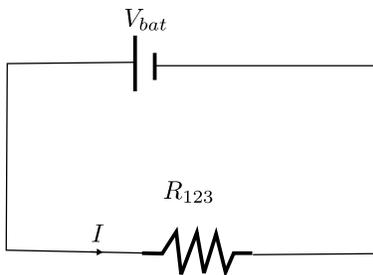
Figura 4.36: Paso 2. Circuito equivalente tras haber agrupado todas las resistencias. Ahora es fácil calcular la intensidad total  $I$  que recorre el circuito.
