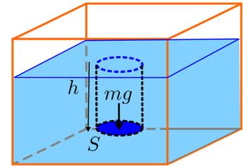
Figura 2.4: Variación de la presión con la profundidad.
