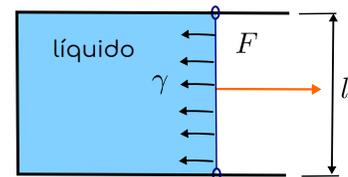
Figura 2.27: Experimento para medir la tensión superficial. Cuando la fuerza  $F$  equilibra a la fuerza de la tensión superficial entonces el alambre no se desliza y la película de agua ni crece ni decrece. Este valor es  $F = 2\gamma l$  donde  $\gamma$  es el coeficiente de tensión superficial, el factor 2 se debe a que la película de agua tiene 2 superficies de contacto con el aire y  $l$  es la longitud del alambre móvil donde actúan las fuerzas.
