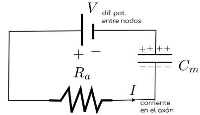
Figura 4.52: Circuito que representa eléctricamente la depolarización del nodo siguiente al que se encuentra el potencial de acción, separados una distancia  $X$ . Se muestra el condensador con polarización normal, el potencial de la batería tiende a descargar y después cargarlo con la nueva polaridad.
