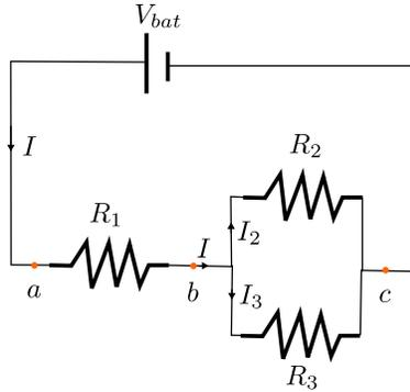
Figura 4.34: Circuito de ejemplo. Son conocidos los valores de las resistencias y el potencial aplicado a todo el circuito.
