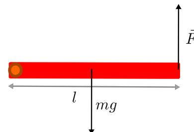
Figura 1.29: Uno esperaría que la fuerza en el extremo necesaria para mantener la barra horizontal es igual al peso. Esto es INCORRECTO!!
