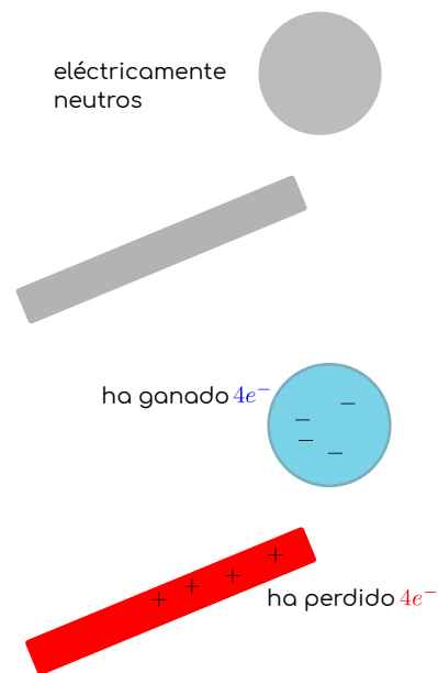
Figura 4.1: Conservación de la carga. Arriba: objetos sin carga inicial o Q_{\text{total}} = 0 . Abajo: los objetos se cargan uno con +4e y otro con -4e de modo que la carga total sigue siendo la misma que antes Q_{\text{total}} = +4e - 4e = 0 .
