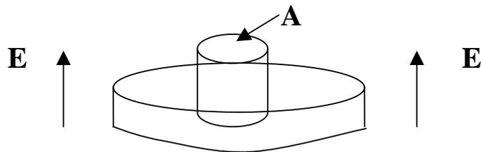
Para hallar el campo eléctrico aplicamos la ley de Gauss al volumen que se muestra en la figura, un pequeño cilindro cuyo eje es paralelo al campo y cuyas caras son paralelas a las de la moneda. Según la ley de Gauss:
