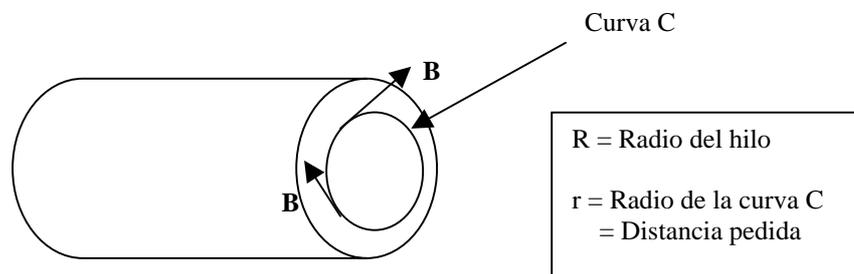
Para hallar el valor del campo magnético aplicamos la ley de Ampere a curvas como la curva C de radios diferentes, sabiendo que por simetría el campo magnético ha de ser tangente a dichas curvas e igual en todos los puntos.
